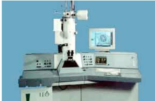
Microscopio elettronico a trasmissione
